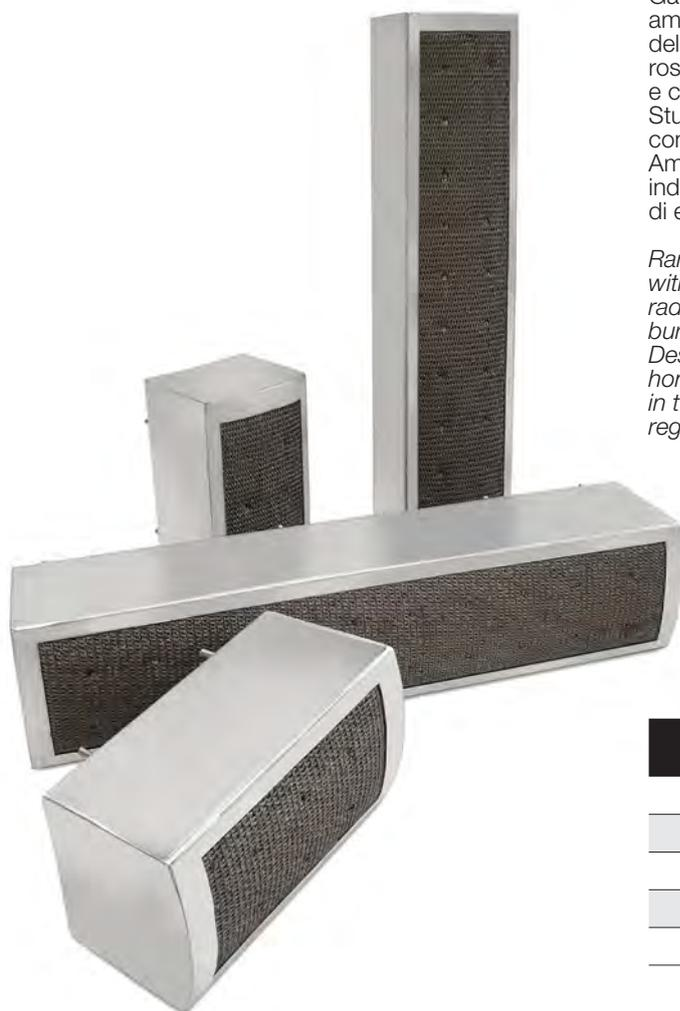
Gamma di bruciatori a configurazione piana rettangolare, ampiamente utilizzati nel settore caldaie murali con ampio range della modulazione della potenza termica, funzionamento in fiamma rossa radiante oppure in fiamma blu e dimensioni parte emittente e chassis bruciatore variabili.
