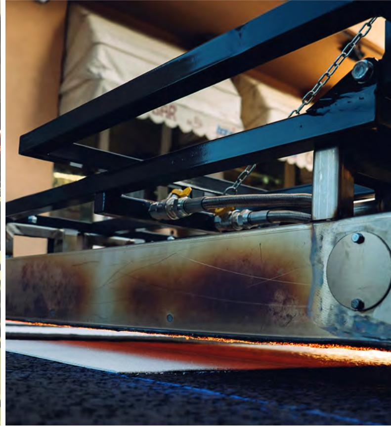
Bruciatori premix per trattamenti termici superficiali ambiente, con possibilità di funzionamento in modulazione oppure in modalità ON-OFF. Tali bruciatori sfruttano appieno l'intensità dei raggi infrarossi in quanto lavorano esclusivamente in fiamma rossa.
